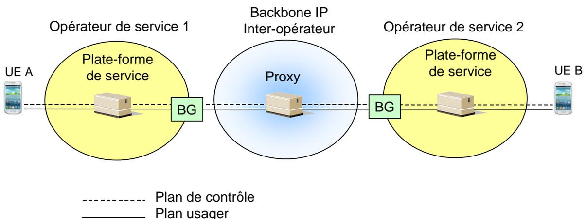
Figure 3 : Signalisation DIAMETER dans le contexte Roaming LTE
